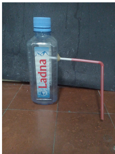
Слика 2. Импровизиран апарат за добивање \text{CO}_2
